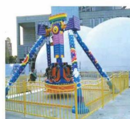
◇ A0917 小型旋转摆锤 规格: 500x300cm 定价: 535000元 功率: 1.1KW 电压: 220-380V
